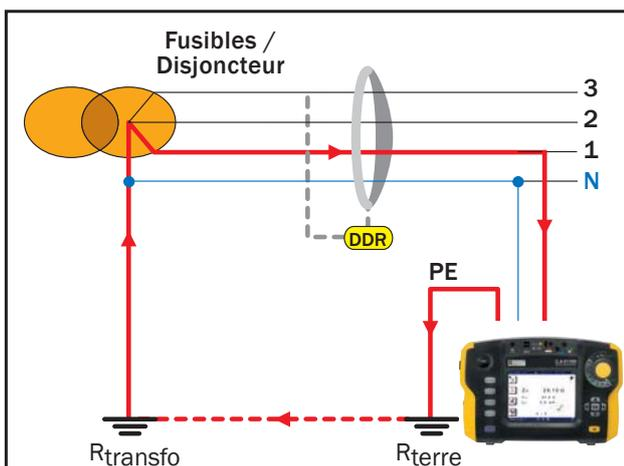
**Remarque :** En schéma TN ou IT (impédant), la mesure de l'impédance de boucle de défaut permettra de calculer le courant de court-circuit et donc de dimensionner correctement les dispositifs de protection.
