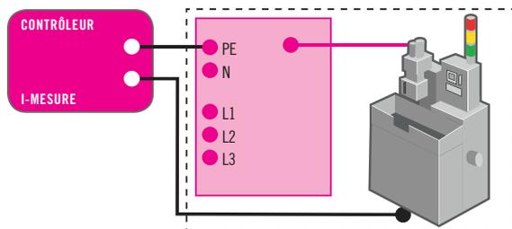
Permet de vérifier si la résistance mesurée correspond à la section et à la longueur du PE.
