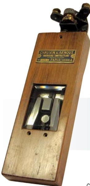
Galvanomètre à réflexion de 1895
