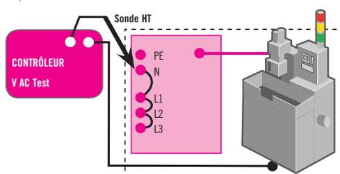
Le test diélectrique AC permet de confirmer l'aptitude du dispositif à fonctionner à sa tension de service. Ces tests se font à une tension supérieure à celle du fonctionnement normal.
