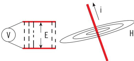
Dans le cas d'une onde alternative sinusoïdale, le champ électrique E et le champ magnétique H sont sinusoïdaux et en phase. Leurs directions sont perpendiculaires entre elles et perpendiculaires à la direction de propagation.
