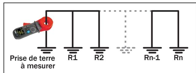
Schéma de principe Méthode à 2 pinces
