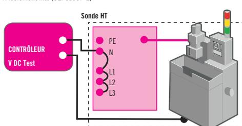
La mesure de la résistance d'isolement permet de détecter des défauts du à la détérioration ou à la pollution et moisissure.
