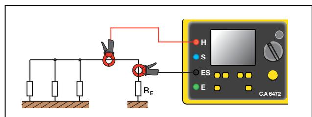
Quant à la méthode 4 pôles + pince, elle nécessite l'utilisation de piquets auxiliaires mais permet une mesure exacte de la résistance de terre.
