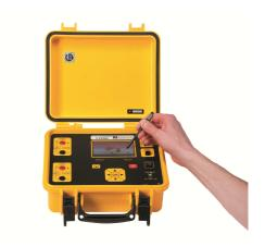
El FTV200 ofrece una ventaja ergonómica excepcional gracias a su biblioteca incorporada que contiene las características de varios millares de paneles solares distintos. La validación de las pruebas se realiza comparando las curvas memorizadas (STC) con las curvas de datos medidos (OPC). La pantalla a color facilita la lectura del resultado.
