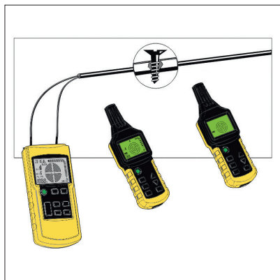
Recherche de court-circuit
